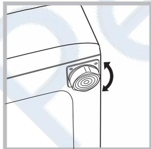
2. Выровняйте машину при помощи регулируемых ножек до полного выравнивания (наклон не должен превышать 2-х градусов).
