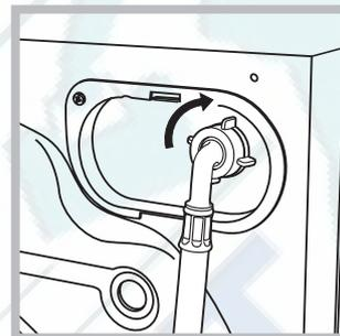
1. Подсоедините шланг к машине, привинтив его к специальному крану, расположенному в задней верхней части справа (см. схему).
